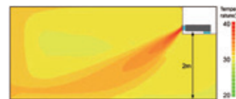
Impulsión de aire con Auto Louver.
